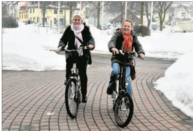
Der Begriff „movelo“ steht für Mobilität und Velo (Fahrrad). Energieverbrauch auf 100 Kilometer: 1 kWh (ca. 20 Cent), Reichweite je nach Gelände: 40 bis 60 Kilometer (Fahrzeit 5 bis 6 Stunden). Die Räder werden für 20 bis 30 Euro pro Tag verliehen.
